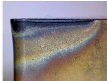
Prime Тип А после 57 минут (износ 0,24 мм)
